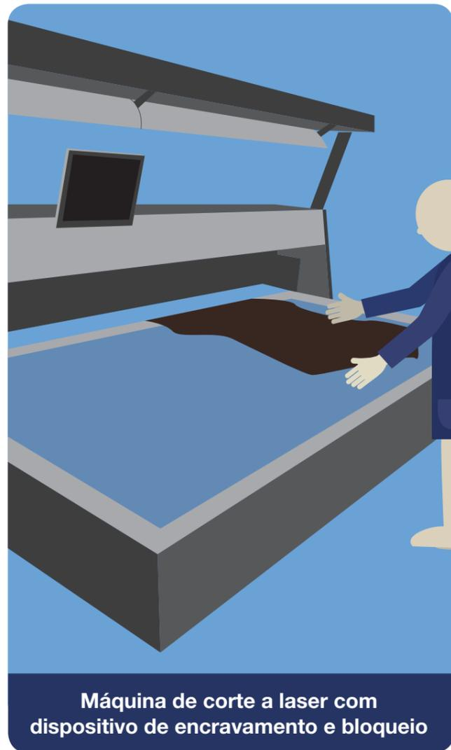
Máquina de corte a laser com dispositivo de encravamento e bloqueio
